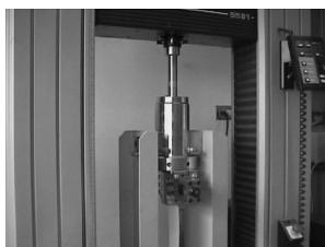
a) Off-line adjustable gap slit die
